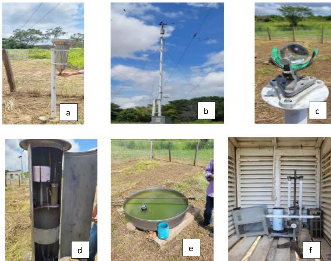
Figura 02: a. Pluviômetro; b. Anemômetro e Anemógrafo; c. Heliógrafo; d. Pluviógrafo; e. Evaporimétrico; f. Higrógrafo e Termômetros.
