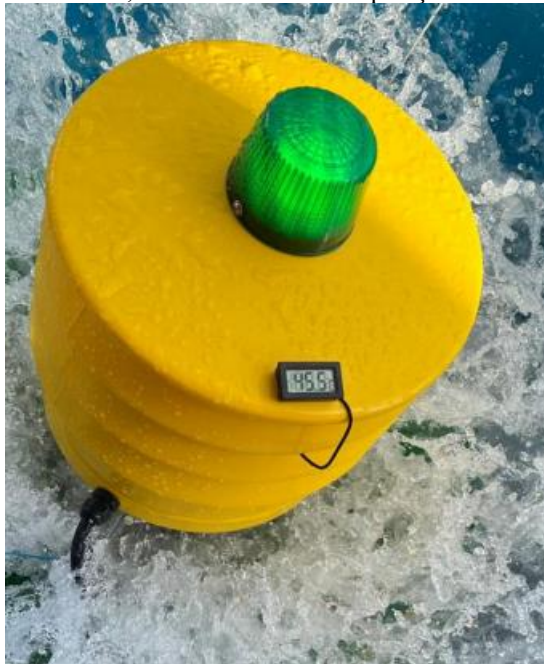
Figura 8. Aerador chafariz de 1,0 CV instalado e em operação no viveiro de carcinicultura.
