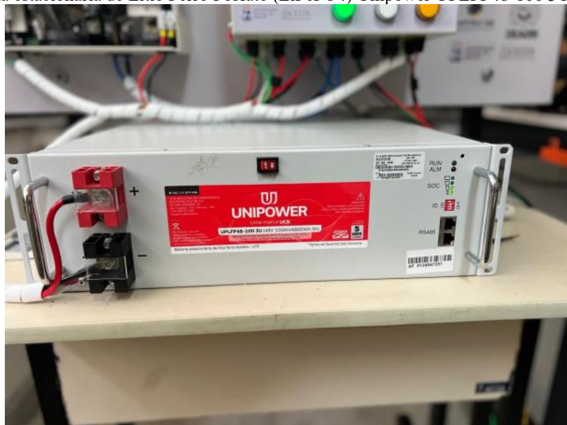
Figura 6. Bateria estacionária de Lítio Ferro Fosfato (LiFePO4) Unipower UPLFP48-100 3U (48 V / 100 Ah).
