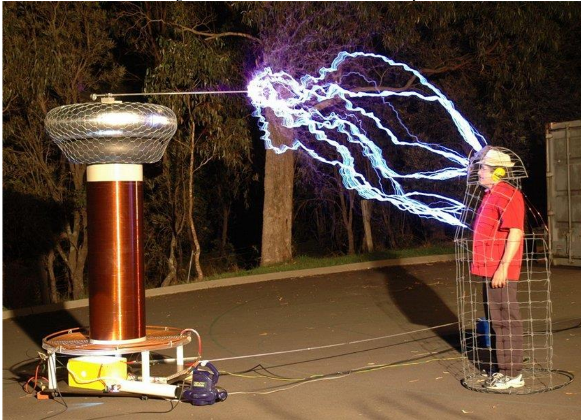
Figura 1 – Funcionamento da Gaiola de Faraday
